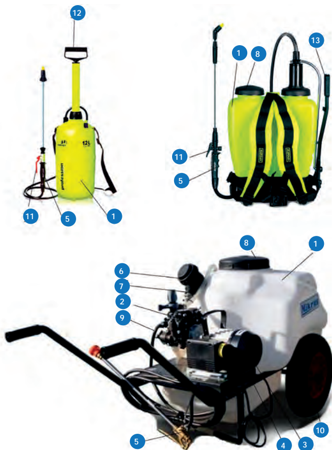
Ryc. III. 61. Opryskiwacze: a) ręczny, b) plecakowy, c) taczkowy; 1 – zbiornik, 2 – pompa, 3 – silnik elektryczny lub spalinowy, 4 – rama podwozia, 5 – lanca opryskująca, 6 – zespół filtra ssawnego, 7 – przewód ssawny, 8 – wlew, 9 – przewód tłoczny, 10 – koło jezdne, 11 – zawór odcinający, 12 – rękojeść pompy tłokowej, 13 – dźwignia pompy wahlweij
